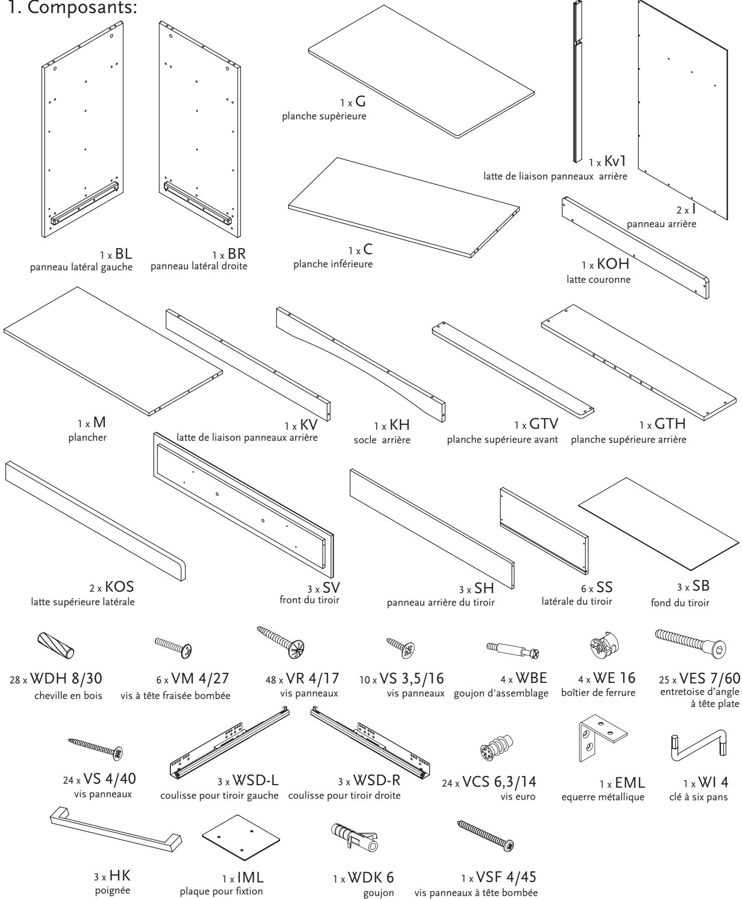
Utiliser pour le montage la clé à six pans ci-inclus et un tournevis. Pour ne pas détériorer le produit, nous vous recommandons de ne pas utiliser un tournevis électrique!
