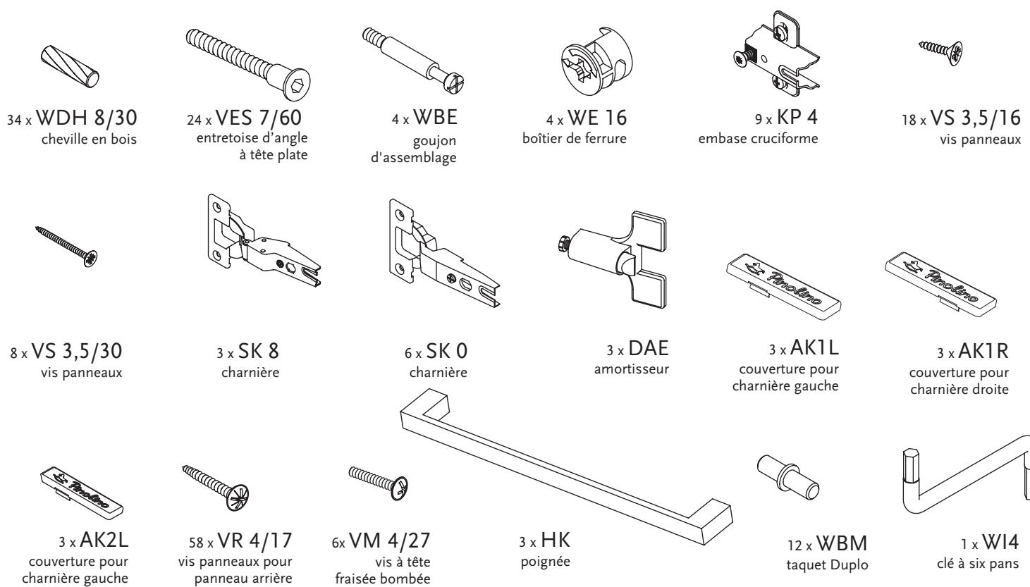
Utiliser pour le montage la clé à six pans ci-inclus et un tournevis. Pour ne pas détériorer le produit, nous vous recommandons de ne pas utiliser un tournevis électrique!
