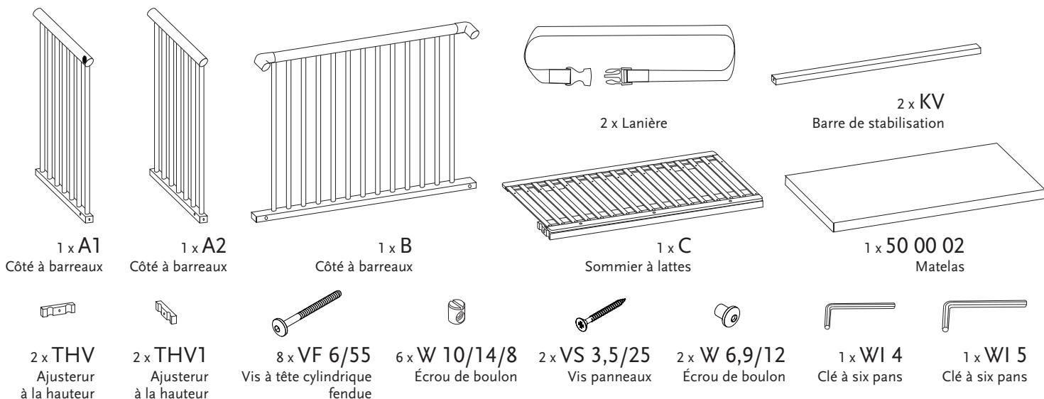
Utiliser pour le montage la clé à six pans ci-inclus et un tournevis. Pour ne pas détériorer le produit, nous vous recommandons de ne pas utiliser un tournevis électrique!
